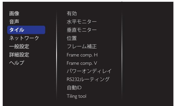
最大 100 台のディスプレイ (縦に最大 10 台、横に最大 10 台) からなる 1 つの大型画面マトリクス (ビデオウォール) を作成します。
